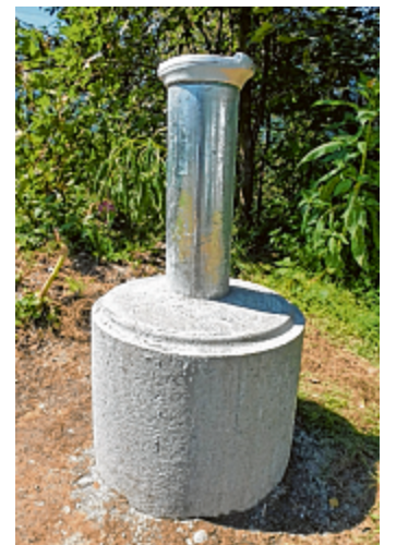
Sonden wie diese liefern Grundlagen für die Nutzung von Grundwasser zum Heizen und Kühlen. Foto: Wasser Tirol
