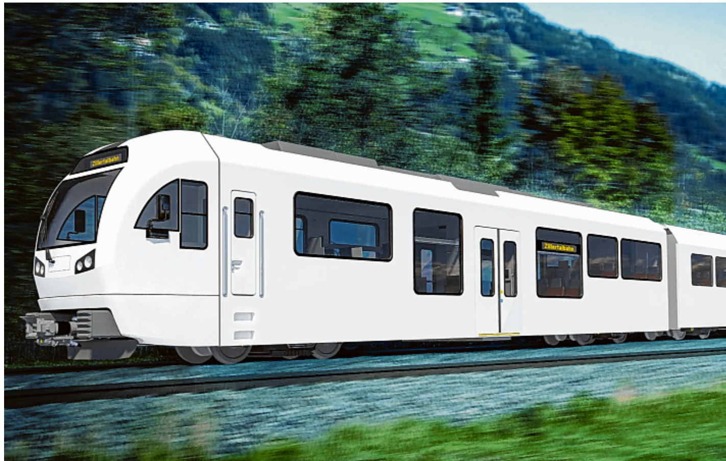
So soll der Prototyp der Zillertalbahn aussehen, die im Jahr 2020 den Probetrieb mit Wasserstoff-Brennstoffzellen aufnimmt.
